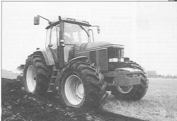
John Deere 7700 bliver i Danmark markedsført med en kraftig dakmontering. Forrest er monteret 600/65 R 28 dæk og bagest er dækkene af størrelsen 710/70 R 38. Med denne dakmontering kan det ikke helt undgås, at farekanten trykkes.
