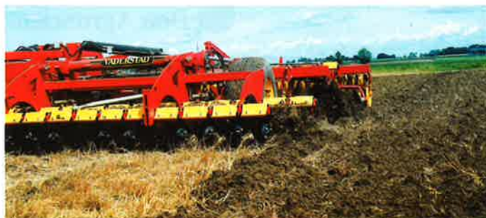
Der sker noget når Vädersstad TopDown går i jorden, og efter en enkelt overkørsel er halm og stubrester effektivt opblandet i jorden, og overfladen efterlades nærmest sort og er lige til at gå på med såmaskinen.
