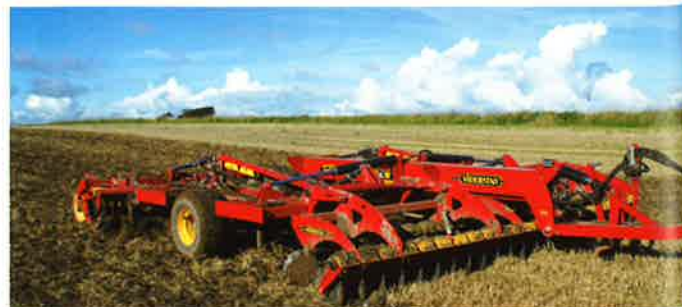
Agrologisk prøvekarde en seks meter bred Vädersstad Topdown efter en John Deere 8530 på 330 heste. Når harven virkelig arbejdede med harvetænderne i cirka 20 centimeters dybde på en JB5 jord, havde de grønne heste nok at gøre.
