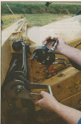
Skærebordets hydraulik tilkobles let med et multibræ. Det eliminerer risikoen for, at der byttes om på slanger.
