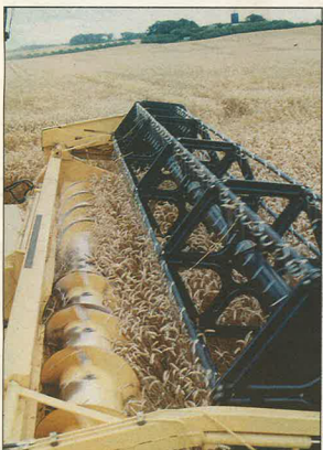
Efter Jens Geertsens mening er et godt skærebord alfa og omega for mejetærskerens kapacitet. Han roser specielt den kraftige vinde og de skråstillede fingre, som i kombination trækker selv den vanskeligste afgrøde ind i maskinen. Til gengæld har han dårlige erfaringer med at montere akselhævere på skærebordet.
